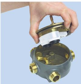
Après avoir retiré manette, capot et vis inox (conserver précieusement les vis inox afin de remonter la cartouche à l'endroit avec les vis inox, ne surtout pas utiliser les vis du kit de rinçage, sortir l'ensemble tampon/cartouche de son logement.
